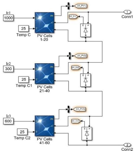
Figure 5. PV array module
